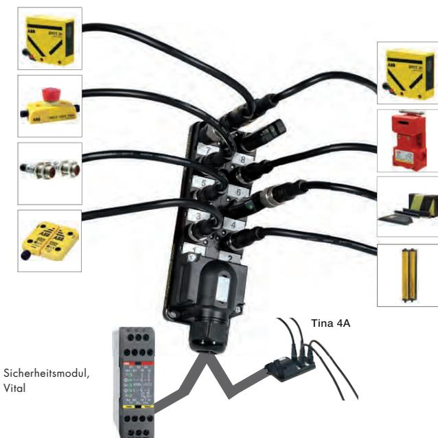
Tina 8A ist ein Anschlussblock mit acht 5-poligen M12-Anschlüssen. Er wird verwendet, um mehrere Sicherheitssensoren mit M12-Kontakten über ein einziges Kabel an eine Steuerung oder SPS anzuschließen. Dies vereinfacht die Kabelführung und reduziert die Kabelkosten. Mehrere Anschlussblöcke können an ein Vital/Pluto angeschlossen werden. Tina 1A wird für unbenutzte M12-Anschlüsse verwendet.
