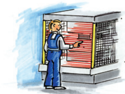
Une résolution pour les doigts ( \leq 14 mm) donne C = 0
