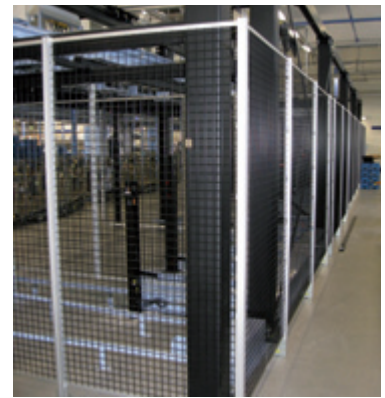
Quick-Guard E avec moins de composants et une orientation facile jusqu'à 45°.
