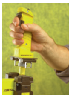
Poignée JSHD4 montée sur une unité de commande de machine.
