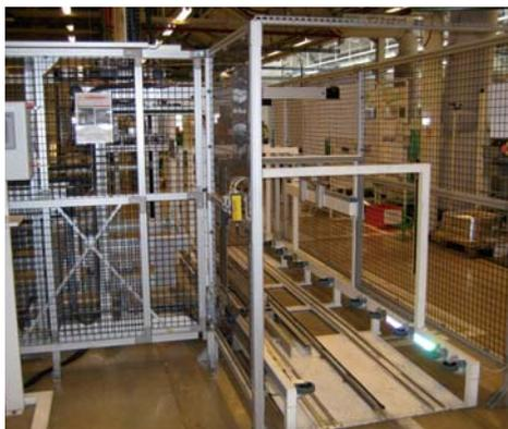
Quick-Guard Standard mit Gitter zusammengebaut.
